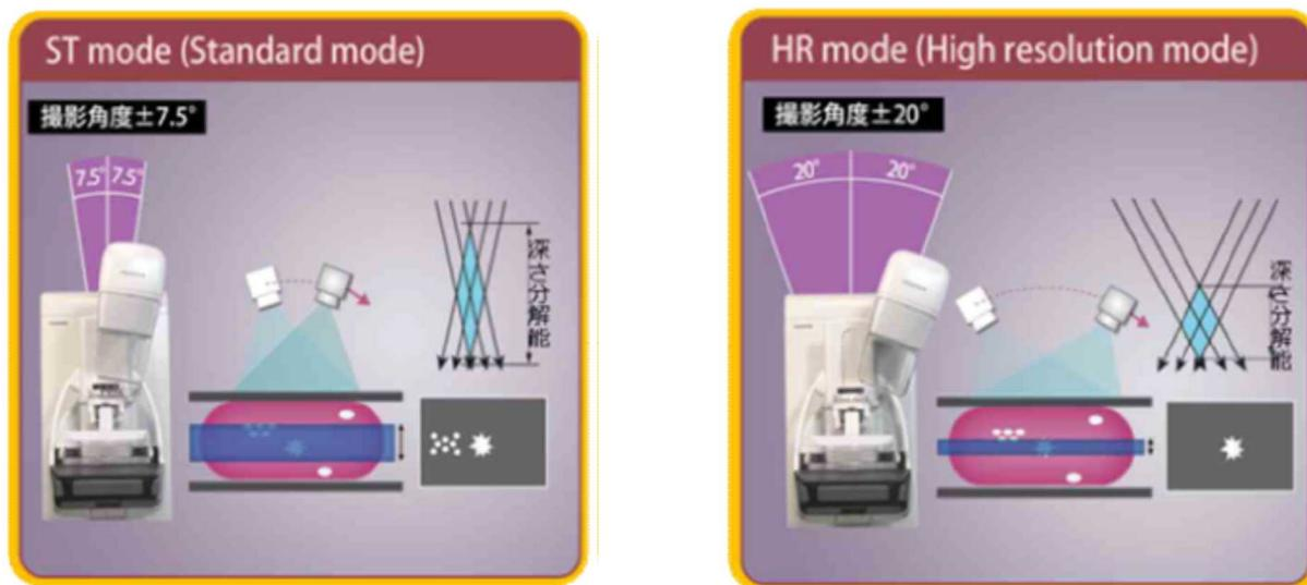
Fig.3 トモシンセシスモードと深さ分解能
