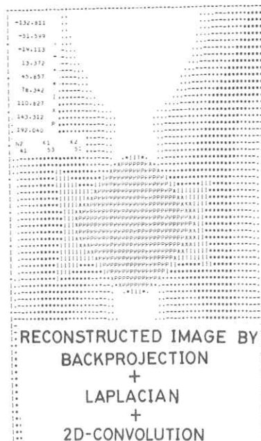
図7. 図6のスカラー場と補正関数のコンボリューションを行って得た再構成像
