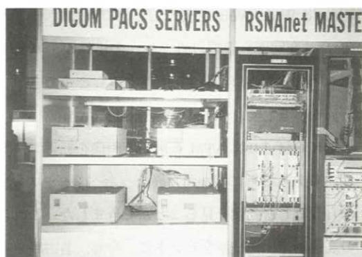
写真5 infoRAD 展示会場内に設置されたDICOM PACSサーバー群とRSNAnetのATM、光ファイバーNode。
