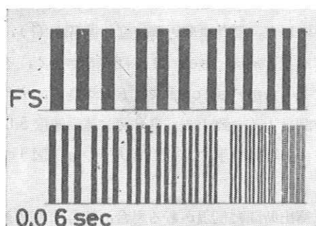
(a) 被写体の運動 3 mm/sec 露出時間 FS : 0.06sec, HS : 0.02sec
