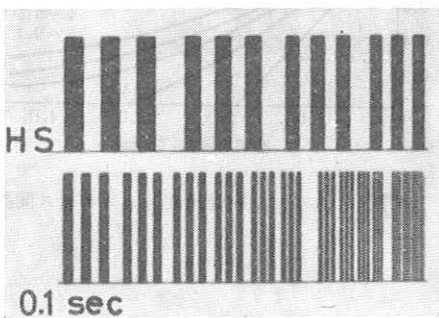
(b) 被写体の運動 3 mm/sec 露出時間 FS : 0.3sec, HS : 0.1sec
