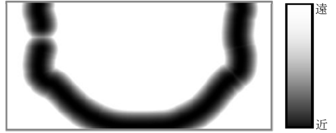
図 4 ユークリッド距離画像。輪郭からの距離が遠いほど、グレースケール値が高くなる。
