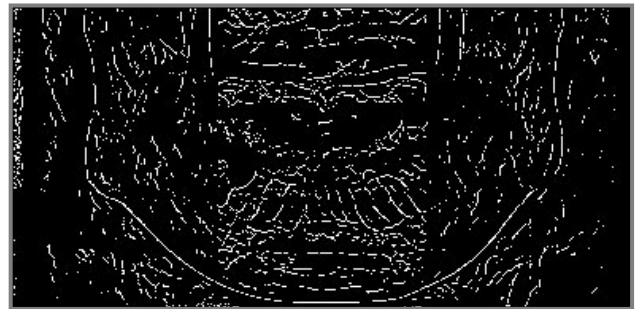
図 1 Canny フィルタによるエッジ検出結果の例
